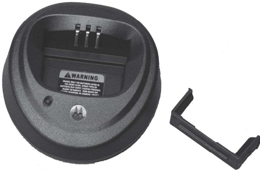
Figure 2 Rail de positionnement de la batterie retiré
