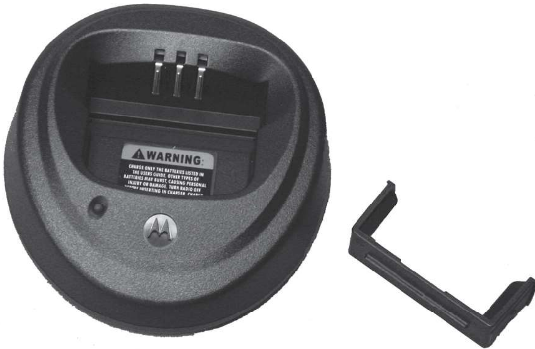
圖 2 已移除電池定位導軌
